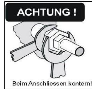
Bezugnehmend auf das Vorstehende, wird vom Hersteller eindeutig empfohlen, elastische Anschlusschläuche (können als PPH Zubehör bestellt werden, Länge 300 mm, DN 20) oder sogen. Wellrohrkompensator zum Anschließen der Stutzen des Wärmetauschers an das Warmwassersystem einzusetzen.
