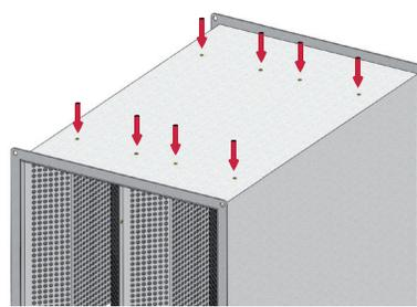
Die Zellendämpfer werden in der Rohrleitung mit Blechschrauben oder Nieten verbunden. Die Verbindungen sollten immer in dem horizontalen sowie dem vertikalen Teil des Zellschalldämpfers angebracht werden. Die Reihenfolge und die Lage der Zellschalldämpfer spielen bei der Montage in der Rohrleitung keine Rolle. Wir empfehlen, die Zellschalldämpfer in der Leitung so zu fixieren, dass durch die Befestigung die Luftströmung nicht beeinträchtigt wird.
