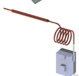
PTT Eingebauter austauscher-Schutz mit kapillare gegen Einfrieren mit Ausgang für Ventilsteuerung ETV oder ETVT, Schutzart IP42, 230V/50 Hz/3A/AC15, Schaltkontakt, Arbeitsumfang 5-35°C, empfohlene Einstellung: 10°C
