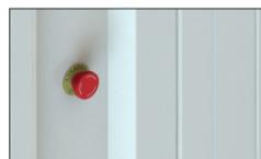
**STOP-Taste:** Für die sofortige Abschaltung der Maschine gibt es auf dem Containermantel zwei Sicherheitstasten mit Feststellvorrichtung.
